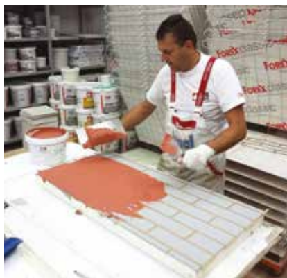
Obr. 2: Příprava vzorku fasády JUBIZOL Brick
